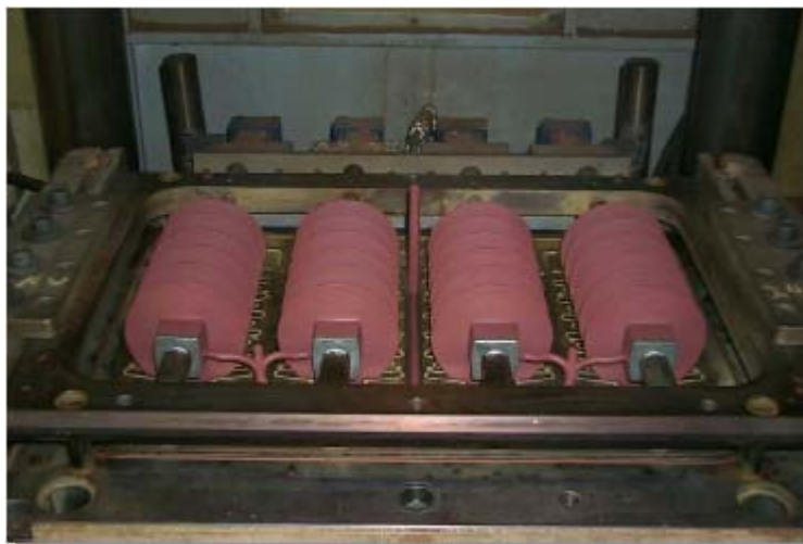
Slika 4.2. Primjer nove metode proizvodnje kućišta ZnO odvodnika
